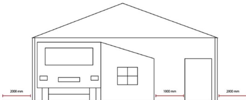
La estructura metálica debe tener cobertura de clase M2, siendo de color verde o gris. Su colocación debe ser de 40 cm, con respecto a la caravana y la cocina, y a 2 metros de las estructuras circundantes, ya sea en los frentes o en los laterales.
