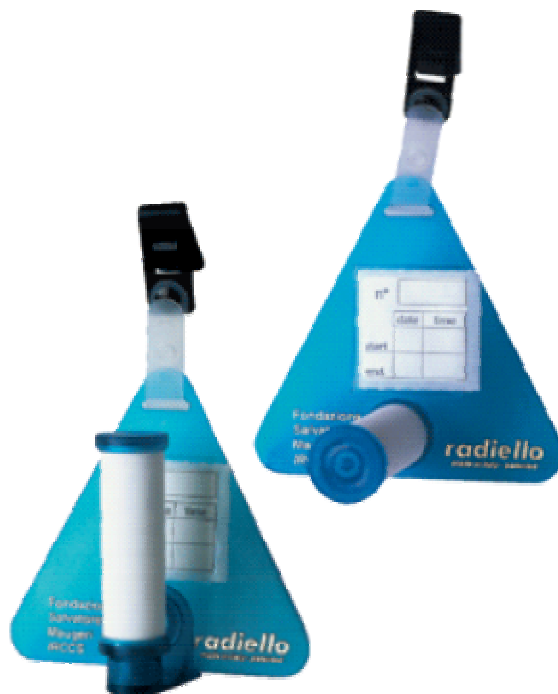
Figura 7: Exemplo de um dos amostradores passivos a utilizar na campanha de medição
