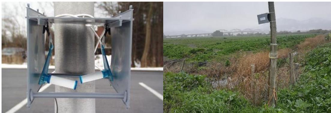
**Figura 3 – Instalação de tubos de difusão no terreno**
