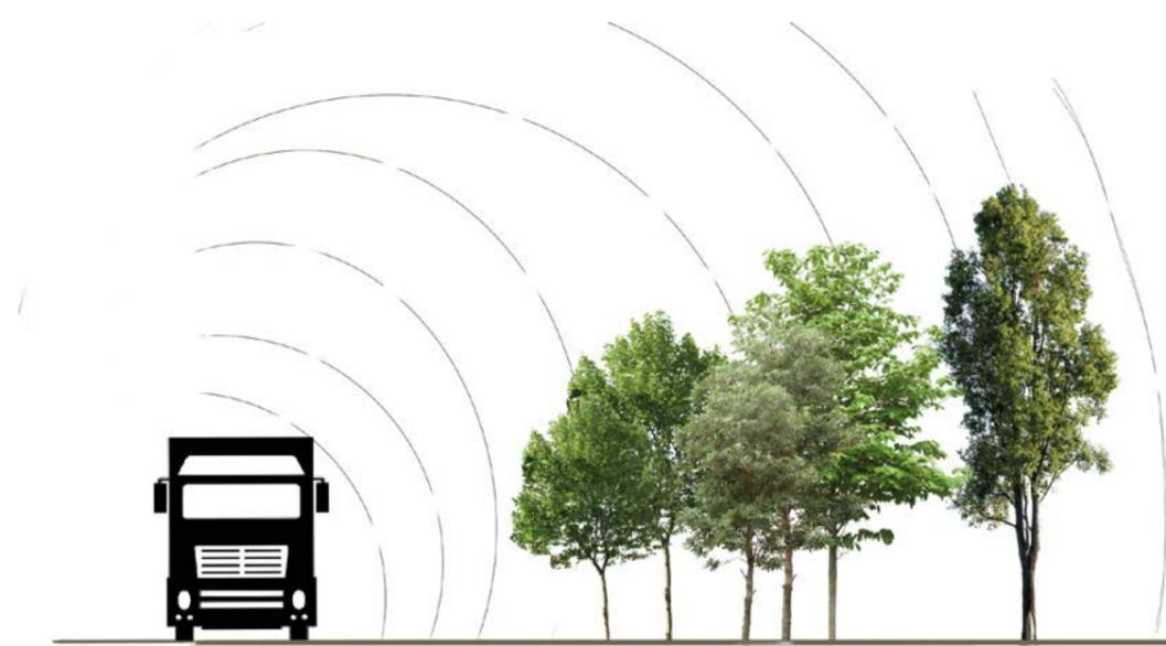
Figura 5 - Esquema ilustrativo da contribuição da vegetação como efeito barreira do ruído
