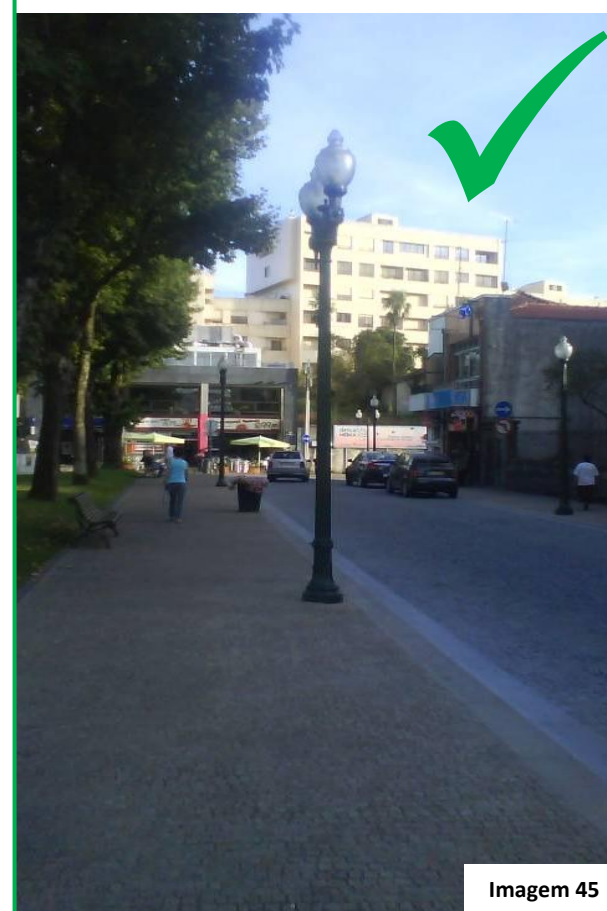
Candeeiro fora do canal de circulação pedonal
