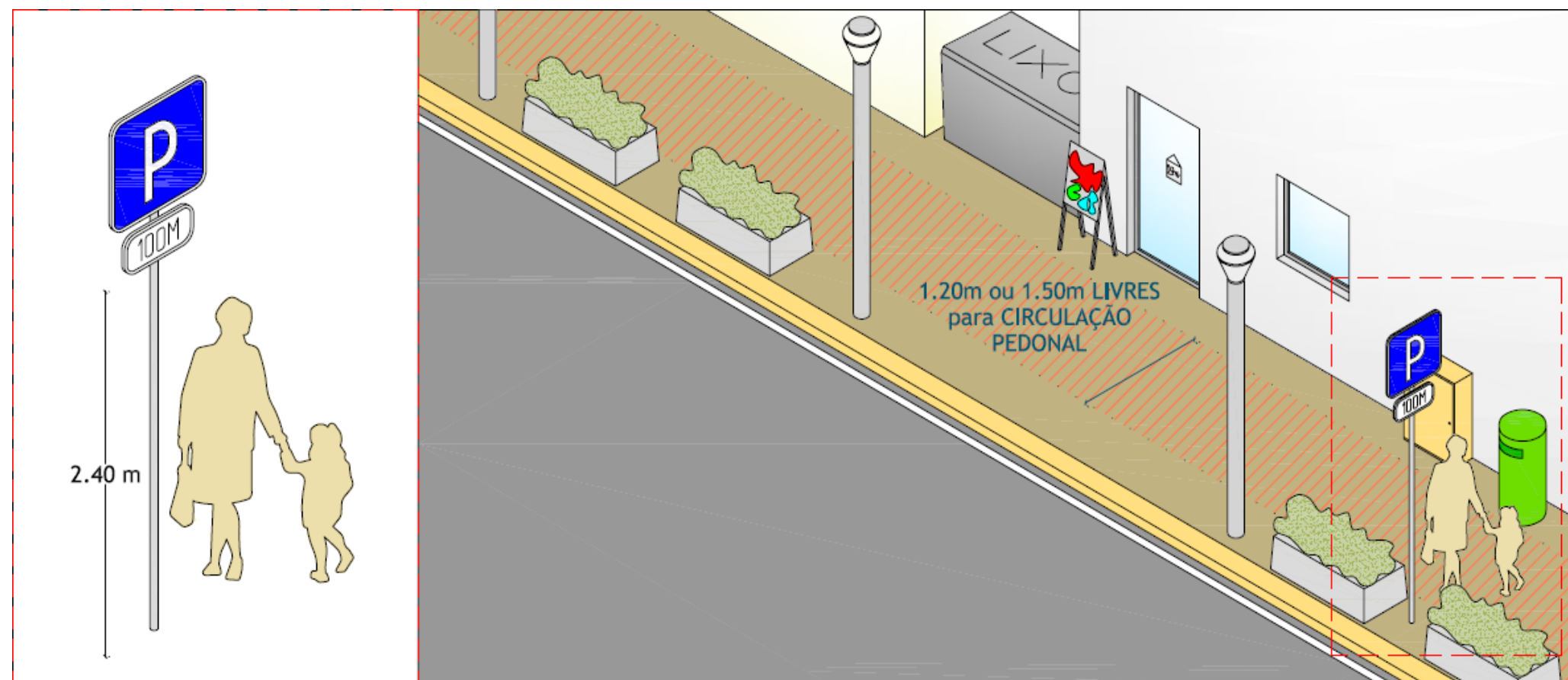
Imagem 06 | Passeio correctamente dimensionado e organizado. A sua estrutura contempla dois canais distintos – um para circulação pedonal e outro para infra-estruturas.
